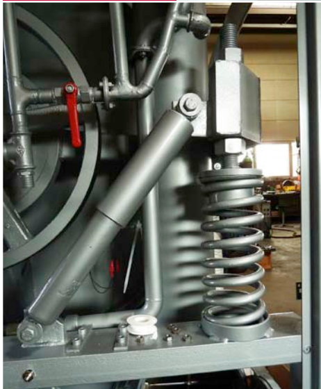
Aufhängung Trommel, Tank, Luftkanal
